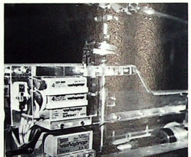
„varioprop“-Empfängerbausteine in einem Hubschrauber-Modell
